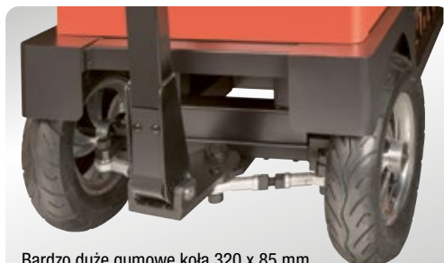
Bardzo duże gumowe koła 320 x 85 mm do stosowania w trudnych warunkach terenowych
